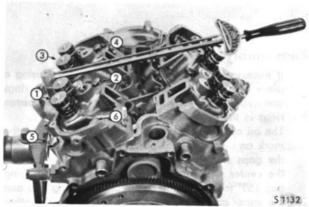
TORQUING THE CYLINDER HEAD
