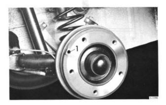
INSPECTION HOLE IN BRAKE DRUM
